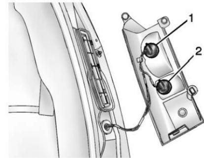
6. Para quitar el receptáculo de la bombilla de la luz de señal direccional/trasera (1) o la luz de reversa (2), gírelo en sentido contrario a las manecillas del reloj un cuarto de vuelta y tire de él para sacarlo del ensamble de la luz.
