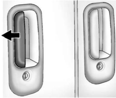
Para abrir la puerta lateral deslizante desde el exterior, jale la manija hacia la parte trasera del vehículo y deslice la puerta para abrirla.
