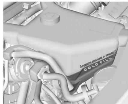
Cuando el motor está frío, el nivel del refrigerante debe estar por lo menos en la marca COLD FILL (Llenado en frío). De no ser así, podría haber una fuga en el sistema de enfriamiento.
