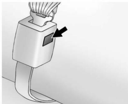
1. Para ello, presione con la punta de una llave en el orificio para soltar la hebilla del cinturón de seguridad al mismo tiempo que jala el cinturón hacia arriba.
