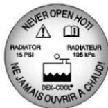
1. Quite el tapón de presión del radiador cuando el sistema de enfriamiento, incluyendo el tapón de presión del radiador y la manguera superior del radiador, ya no estén calientes. Gire el tapón de presión lentamente en sentido contrario a las manecillas del reloj hasta que se detenga primero. No presione el tapón mientras lo gira.
