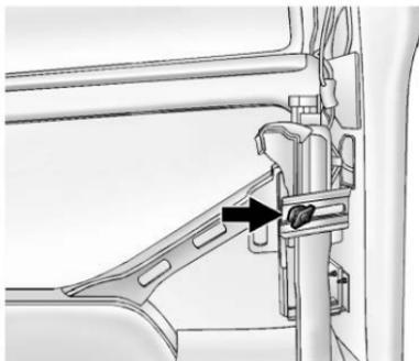
Quite el tornillo de mariposa de retención y levántelo para sacarlo del soporte de montaje.
