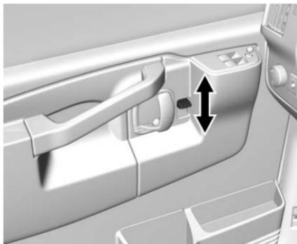
Para activar el seguro de la puerta desde el interior, deslice la palanca manual de la puerta hacia abajo. Para quitar el seguro a la puerta, deslice la palanca manual hacia arriba.
