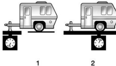
El peso de la lengüeta de remolque (1) debe ser 10–15 % del peso del remolque cargado (2). Algunos tipos de remolques específicos, como remolques de bote, están fuera de estos rangos. Siempre consulte el manual de propietario del remolque para el peso de lengüeta de remolque recomendado para cada remolque. Nunca exceda las cargas máximas para su vehículo, gancho y remolque.
