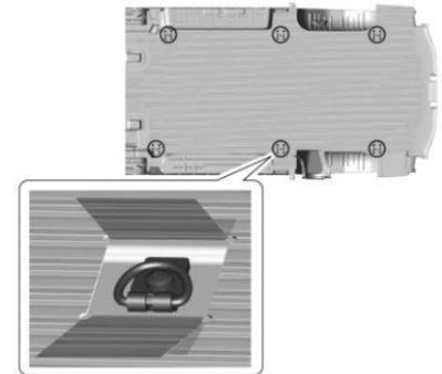
Si está equipado, hay seis amarres de carga en el área de carga que se puede utilizar para asegurar la carga.
