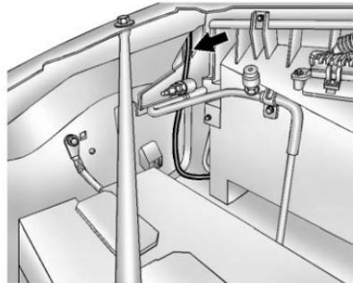
8. Conecte el otro extremo del cable negativo (-) a la ubicación de la terminal negativa (-) en el vehículo que tiene la batería descargada. En su van, utilice un soporte de antena de radio sin pintar como terminal negativa (-) remota.
