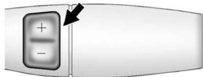
Si está equipado, el módulo de selección de rango ayuda a controlar la transmisión y la velocidad del vehículo mientras maneja cuesta abajo o al jalar un remolque al permitirle seleccionar el rango deseado de cambios.
