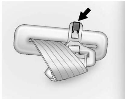
En la última fila de asientos, estibe la placa del cerrojo del cinturón de seguridad en el broche del revestimiento de la ventana. Enrolle el mini anclaje en el tejido del cinturón de seguridad y abrahe la placa del anclaje del cinturón de seguridad en el clip.
