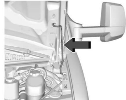
3. Levante el cofre y libere la varilla del soporte del cofre de su retenedor en el frente del compartimiento del motor. Inserte firmemente el extremo de la varilla en la ranura marcada con una flecha, en el lado inferior del cofre.
