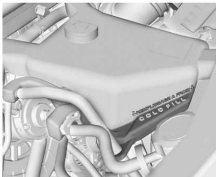
4. Retire la tapa del tanque de recuperación de refrigerante y llénela hasta la marca COLD FILL (Llenado frío).
