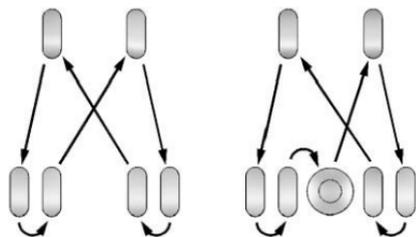
Use este patrón de rotación al realizar la rotación de las llantas si el vehículo tiene ruedas traseras duales.
