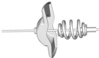
Incline el retenedor y tire de él a través del centro de la rueda, junto con el cable y el resorte.
