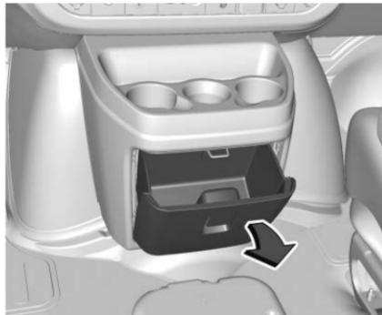
Si está equipado, el compartimiento de almacenamiento delantero está al centro de la extensión del tablero de instrumentos cerca del piso. Para abrir, jale el seguro.
