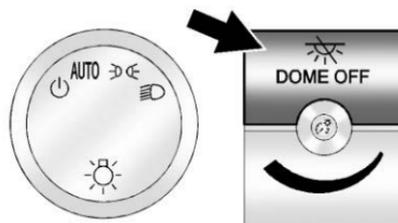
La anulación de luz de techo ajusta las luces de techo para permanecer apagadas o encenderse automáticamente cuando se abre una puerta, se presiona el desbloqueo remoto, o cuando se apaga la ignición.
