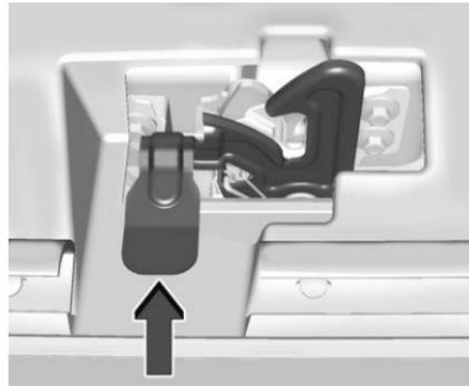
2. Vaya al frente del vehículo y localice la palanca de liberación secundaria debajo del centro delantero del cofre. Empuje la palanca de liberación secundaria del cofre hacia arriba para librear.
