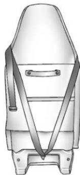
Si la posición que usa tiene apoya cabezas o cabecera y utiliza una atadura dual, dirija la atadura alrededor de la cabecera o apoya cabezas.
