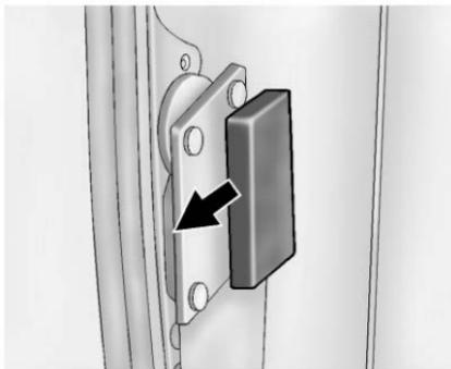
Para abrir la puerta trasera del lado del conductor, jale la manija de desbloqueo en el borde interior de la puerta.
