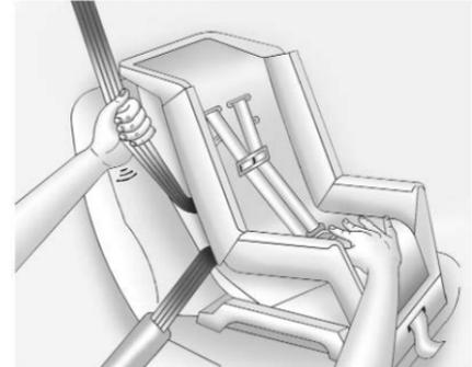
6. Para apretar el cinturón, empuje hacia abajo el asiento de seguridad para niños, jale la porción del hombro del cinturón para apretar la porción de la cintura del cinturón, y regrese el cinturón de hombro dentro del retractor.
