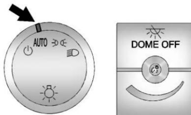
El control de luz exterior está en el tablero de instrumentos a la izquierda del volante de dirección.
