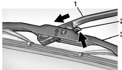
2. Empuje la palanca de liberación (2) para desacoplar el gancho y empuje el brazo del limpiador (1) hacia fuera del ensamblaje de la pluma (3).
