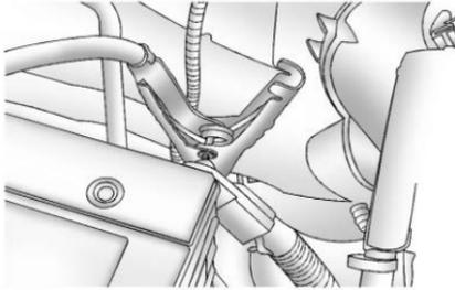
6. Conecte el cable positivo (+) rojo a la terminal positiva (+) de la batería descargada. Use una terminal positiva (+) remota, si el vehículo cuenta con ella. No permita que el otro extremo toque ninguna superficie metálica. Conecte el otro extremo del cable positivo (+) rojo a la terminal positiva (+) de una batería en buenas condiciones. Use una terminal positiva (+) remota, si el vehículo cuenta con ella.
