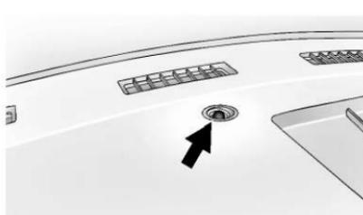
El vehículo tiene un sensor de luz en la parte superior del tablero de instrumentos. No cubra el sensor; de lo contrario el sistema se encenderá cuando se encienda el vehículo.
