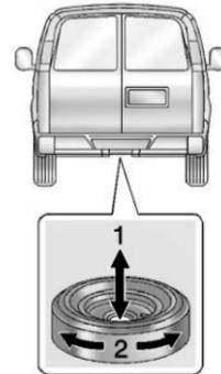
8. Cerciérese de que la llanta quede guardada de manera segura. Empuje, tire de la llanta (1) y después trate de girarla (2). Si la llanta se mueve, use la llave para las ruedas para apretar el cable.
