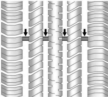
Los indicadores de desgaste del dibujo son una de las maneras de decidir cuándo es el momento para nuevas llantas. Los indicadores de desgaste aparecen cuando las llantas tienen solamente 1.6 mm (1/16 de pulgada) de dibujo remanente. Vea *Inspección de llantas* ⇨ 240 y *Rotación de la llanta* ⇨ 241.
