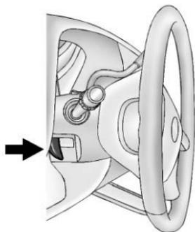
En vehículos con un volante ajustable, la palanca se encuentra del lado izquierdo de la columna de la dirección.
