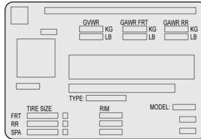
En el borde trasero de la puerta del conductor se encuentra pegada una etiqueta de certificación/llantas específica del vehículo. La etiqueta puede mostrar el tamaño de las llantas originales del vehículo y las presiones de inflado necesarias para obtener la capacidad de peso bruto del vehículo. Esto se denomina Clasificación de peso
