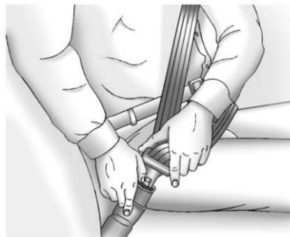
Para desabrochar el cinturón, presione el botón de liberación de la hebilla. El cinturón debería regresar a su posición de almacenamiento. Deslice la placa del seguro hacia arriba del tejido del cinturón de seguridad cuando no esté utilizando el cinturón de seguridad. La placa debe reposar sobre la costura del cinturón de seguridad, cerca del aro guía de la pared lateral.
