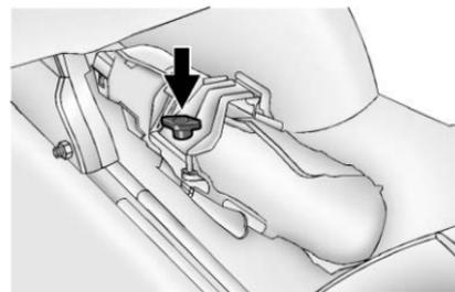
Remueva el tornillo de mariposa de retención y levántelo para sacarlo del soporte de montaje para tener acceso al equipo.
