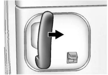
Para abrir la puerta lateral deslizante desde el interior, jale la manija hacia la parte trasera del vehículo. Después, deslice la puerta hacia la parte trasera del vehículo.
