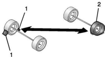
1. Si está equipado, coloque bloques de rueda (1), como se muestra, para evitar que el vehículo se mueva.
