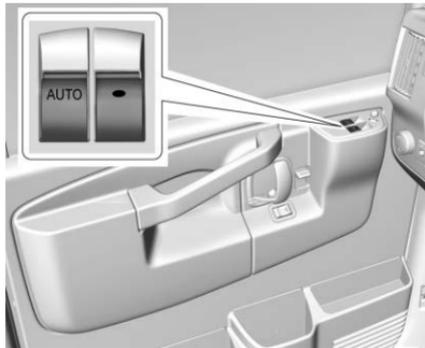
Si está equipado, las ventanas eléctricas funcionan cuando la ignición está encendida, en modo de accesorios, o cuando la Energía retenida para los accesorios (RAP) está activa. Consulte *Energía retenida para los accesorios (RAP)* ⇨ 148.
