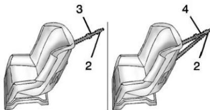
Una atadura superior (3, 4) se utiliza para asegurar la parte superior del asiento para niños al vehículo. Un anclaje de atadura superior está integrado al vehículo. El gancho de sujeción de atadura superior (2) sobre el asiento de seguridad para niños se conecta al anclaje de atadura superior del vehículo para reducir el movimiento hacia el frente y la rotación del asiento de seguridad para niños durante la conducción en un evento de un choque.
