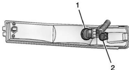
1. Luz de estacionamiento y direccional delantera
