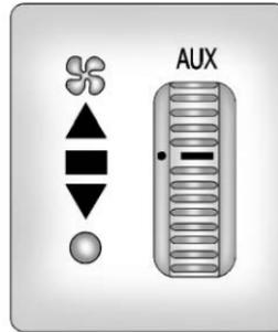
**AUX** : La rueda de ajuste para este sistema se encuentra en el tablero de instrumentos debajo del sistema de audio.
