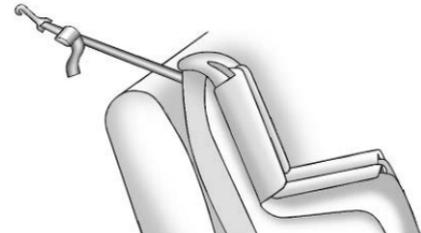
Si la posición que usa no tiene cabecera o reposacabezas y utiliza una atadura sencilla, dirija la atadura sobre el respaldo.
