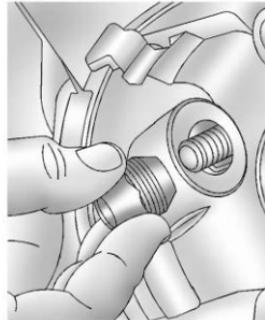
9. Coloque de nuevo las tuercas de la rueda, con el extremo redondeado de las tuercas hacia la rueda. Apriete cada una de las tuercas a mano hasta que la rueda esté en contacto con el cubo.
