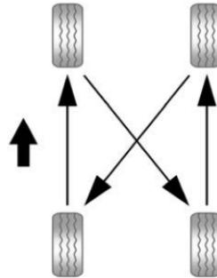
Use este patrón de rotación al hacer rotación de los neumáticos si el vehículo tiene ruedas traseras sencillas.
