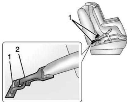
Los anclajes inferiores (1) son barras de metal integradas al vehículo. Hay dos anclajes inferiores para cada posición de asiento LATCH que acomodarán un asiento para niños con sujetadores inferiores (2).
