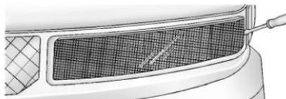
1. Use una herramienta pequeña para desenganchar el broche exterior en la luz, empujándolo hacia dentro y levantando el ensamble de la luz hacia delante.
