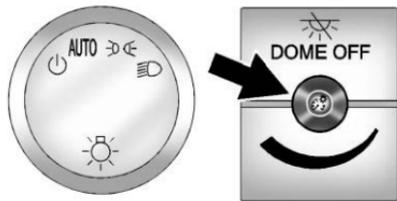
Esta función ajusta el brillo de todos los controles iluminados. El control de iluminación del tablero de instrumentos está junto al control de la luz exterior.
