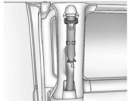
8. En los asientos de la segunda y tercera filas, para estibar el cerrojo del cinturón de seguridad, fije el broche del cerrojo del cinturón de seguridad al revestimiento justo en el interior de la puerta lateral.
