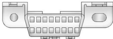
El DLC está debajo del tablero de instrumentos del lado izquierdo del volante. Conectar dispositivos que no se utilicen para realizar una Inspección de emisiones/Prueba de mantenimiento o para dar servicio al vehículo puede afectar la operación del vehículo. Vea *Equipo eléctrico incorporado* ⇨ 192. Visite a su distribuidor si necesita asistencia.
