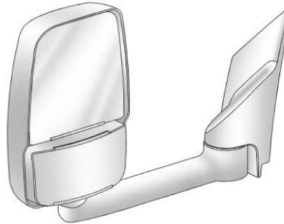
En los vehículos con espejos de remolque, éstos se pueden ajustar en forma manual para que obtenga una visión clara de los objetos detrás de usted.
