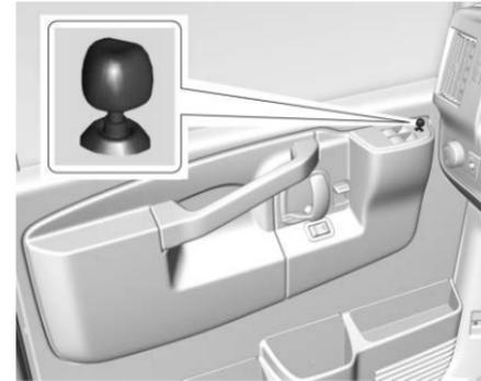
Si está equipado con espejos eléctricos, seleccione cada espejo girando la perilla en sentido de las manecillas del reloj para el espejo del lado del pasajero, o en sentido contrario a las manecillas del reloj para el espejo del lado del conductor. La posición central es neutral.
