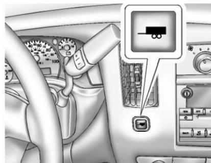
Si está equipada, la Modalidad de remolque/arrastre ajusta el patrón de cambio de la transmisión para reducir el ciclo de cambio, proporcionando un aumento de rendimiento, control de vehículo y enfriado de la transmisión mientras se remolcan o arrastran cargas pesadas.
