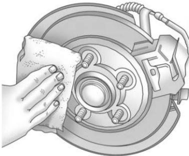
8. Elimine todo el óxido y la suciedad de los pernos de la rueda, las superficies de montaje y la rueda de refacción.
