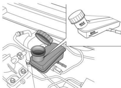
Si el nivel es inferior a la marca MIN, se iluminará la luz de advertencia del sistema de frenos (roja) en la pantalla del centro de información. Indica que el sistema de frenos no funciona correctamente. Descubra la razón de inmediato. Si está conduciendo, detenga el vehículo con cuidado e inmediatamente y comuníquese con su distribuidor de servicio para obtener servicio lo antes posible. No continúe conduciendo.
