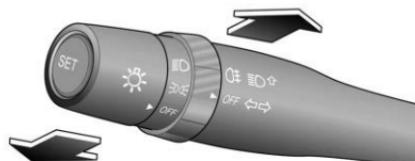
Empuje el interruptor de la palanca de cambios en dirección opuesta al volante para cambiar el modo de los faros delanteros de luz baja a luz alta. Jale el interruptor de la palanca de cambios hacia el volante para cambiar el modo de faros delanteros a luces bajas.
