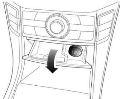
El tomacorriente está ubicado detrás de la parte inferior del descansabrazos central entre los asientos del conductor y del pasajero delantero.
