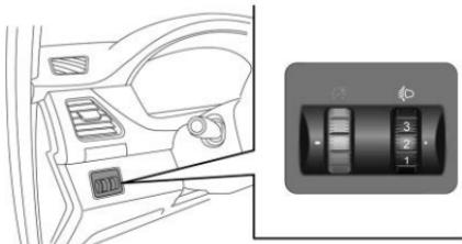
Ajuste la nivelación de los faros moviendo la rueda giratoria hacia arriba o hacia abajo. Con el cambio de carga del vehículo, ajuste la nivelación de los faros de acuerdo con los siguientes requisitos:
