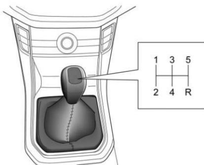
**5 (quinta) velocidad:** Empuje completamente la palanca de cambios hacia el lado derecho con una fuerza mayor que la tensión del resorte y despues empuje la palanca de cambios hacia
