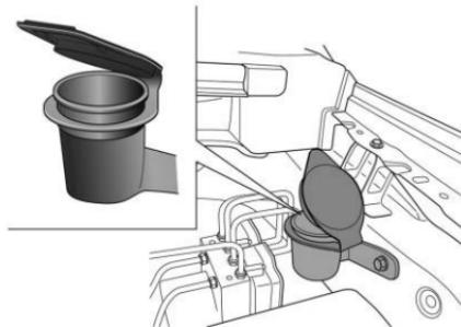
Evite el agua dura al mezclar solventes de lavaparabrisas. Los contaminantes del agua y los minerales pueden tapar los orificios del sistema de lavado y reducir el desempeño.
