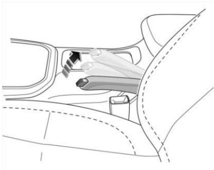
Cuando el interruptor de ignición se coloca en la posición ON, jale hacia arriba la palanca del freno de estacionamiento y la luz de advertencia del sistema de frenos (1) en el grupo de instrumentos se iluminará.
