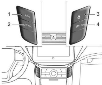
**Posición 1 - ECO:** Interruptor de modo económico. Presione ECO, y entonces el vehículo se conducirá en el modo económico con una potencia del motor relativamente débil.
