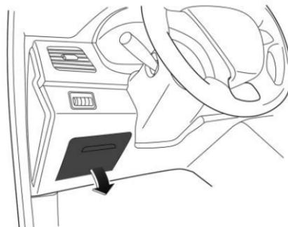
Los fusibles en la caja de fusibles del compartimento del conductor se pueden identificar por la etiqueta en la parte posterior de la cubierta de la caja de almacenamiento inferior en el lado del conductor.
