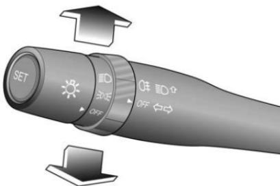
Girar a la derecha – Empuje el interruptor de la palanca de cambios hacia arriba.
