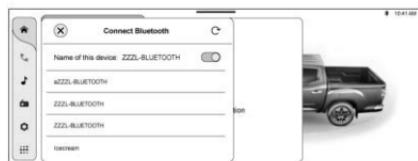
Conecte su teléfono al sistema de infoentretenimiento del vehículo a través de Bluetooth. Asegúrese de seleccionar el nombre del radio del vehículo en su dispositivo móvil y siga los pasos siguientes para completar el proceso de conexión y sincronización de contactos.
