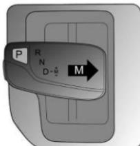
Cuando está en D (Conducción) en el modo automático, cambie a M (Manual) para seleccionar modo manual moviendo la palanca de cambios a la derecha, y cambiar las velocidades empujando o jalando la palanca de cambios hacia adelante o hacia atrás. Para volver a la operación de velocidad
