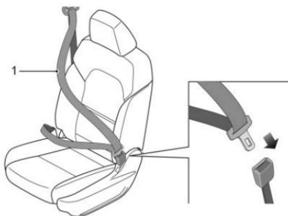
Jale el cinturón de seguridad sobre el hombro suavemente para abrocharse al frente del cuerpo, asegúrese que no esté torcido o atado, y después empuje la placa de seguro en la hebilla.
