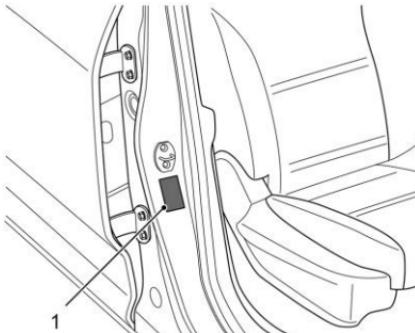
La placa de identificación del vehículo (1) se encuentra en la parte inferior delantera del pilar B derecho.
