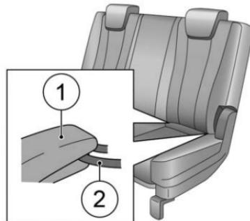
4. Conecte el calibrador de fijación (1) en el asiento de seguridad para niños al dispositivo de fijación en el vehículo (2). Opere de acuerdo con las instrucciones del asiento de seguridad para niños.
