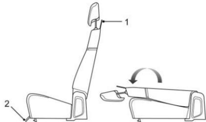
Jale hacia arriba la correa (1) para desbloquear el respaldo, pliegue el respaldo hacia adelante hasta que encaje perfectamente contra el cojín.
