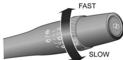
Cuando el interruptor de la palanca de cambios se coloca en
