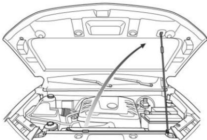
3. Inserte el extremo de la varilla de soporte en la ranura de montaje en el cofre del motor.
