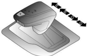
Presione y jale brevemente la palanca de cambios hacia la dirección requerida (dos posiciones para la parte delantera y trasera). Después de soltar la palanca de cambios, la palanca de cambios volverá a la posición central.
