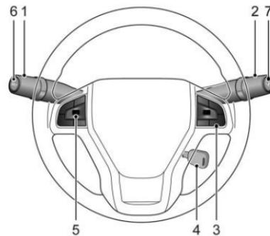
1. Control de luz de combinación e interruptor de palanca de luz indicadora de dirección
