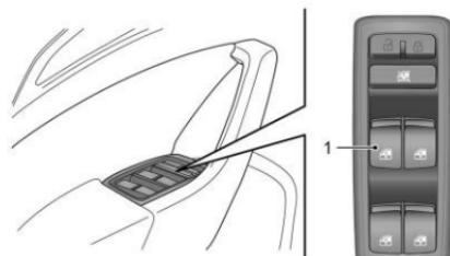
Interruptores de ventana eléctrica en la puerta del conductor de los modelos de una fila y de una fila y media:
