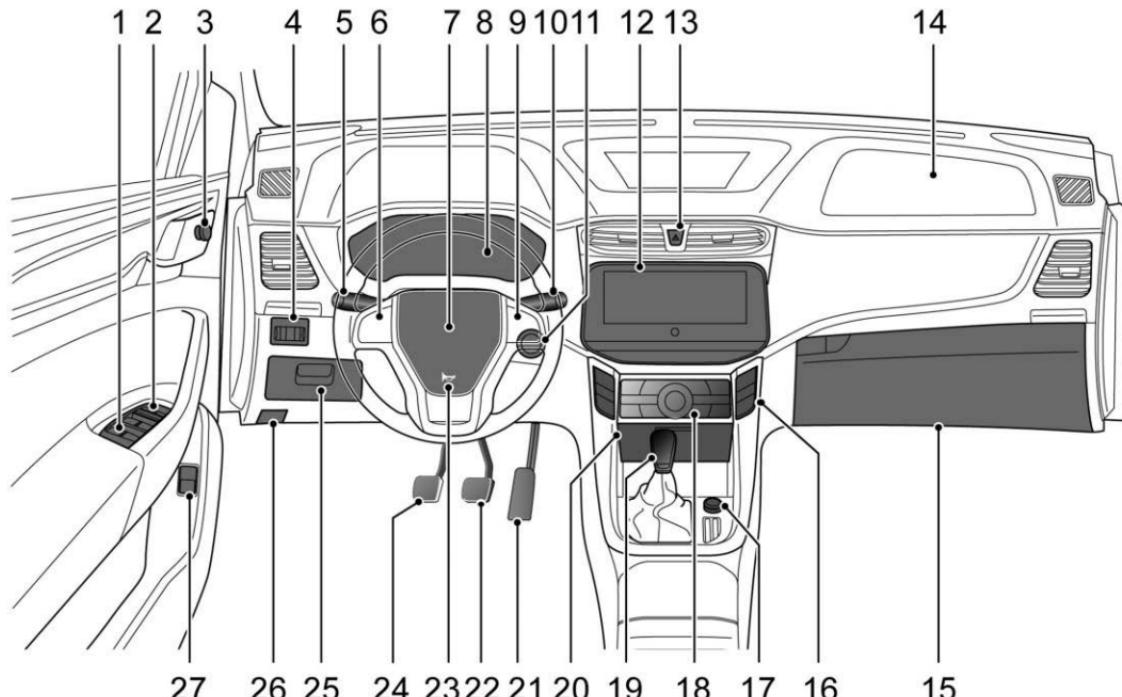
1. Interruptores de control de ventana de puerta | 2. Interruptor de bloqueo central | 3. Interruptor de ajuste eléctrico del espejo retrovisor exterior
