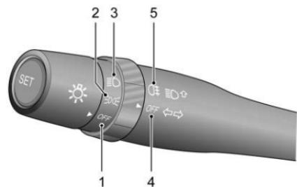
Mueva el interruptor de control de iluminación a la posición que se muestra en la figura, y las luces correspondientes se iluminarán.
