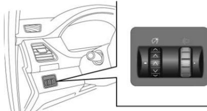
Ajuste el brillo de la iluminación del tablero de instrumentos con el interruptor de rueda giratoria de control de iluminación del tablero de instrumentos . Mueva el interruptor de
