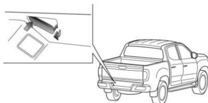
3. Presione el extremo izquierdo de la cubierta con su mano y después abra la cubierta de la defensa trasera.
