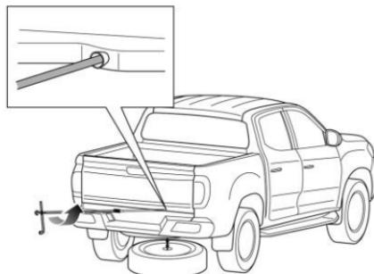
4. Inserte el poste giratorio auxiliar en el orificio de carga/descarga de la rueda de repuesto a través de la cubierta, y luego gire la llave para tuercas de rueda en sentido contrario a las manecillas del reloj para bajar la rueda de repuesto hasta que la rueda llegue al suelo.
