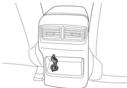
El tomacorriente puede proporcionar energía para dispositivos eléctricos que no superen los 120W.
