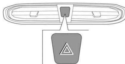
Presione el interruptor de la luz de advertencia de peligro para activar todas las luces direccionales mientras tanto, y la luz indicadora de dirección (verde) en el grupo de instrumentos se iluminará y destellará. Despues presione este interruptor para apagar las luces anteriores.
