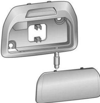
Levante con cuidado la pantalla de la luz con un destornillador o equivalente.
