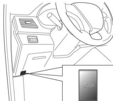
1. Para abrir el cofre del motor, jale la palanca de liberación debajo de la protección contra salpicaduras en el lado del conductor.
