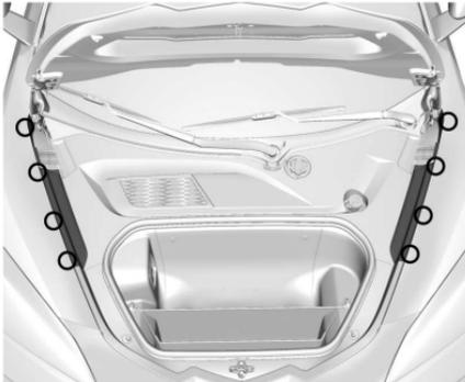
5. Suelte los cuatro sujetadores para las cubiertas exteriores izquierda y derecha.
