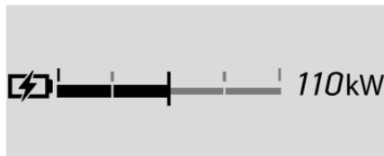
El indicador de energía eléctrica está en la parte inferior de la pantalla a la derecha del velocímetro y sólo se muestra en el modo Transporte.
