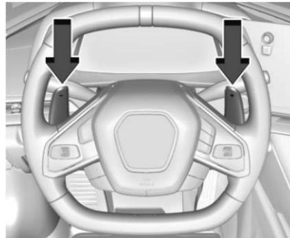
Con la transmisión en D (conducción), presione el interruptor M (Modo manual) en la consola central para entrar al Modo manual. Use las paletas en el volante para hacer un cambio ascendente o descendente
