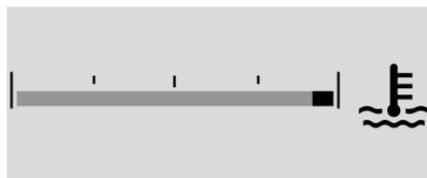
Ese indicador muestra la temperatura del refrigerante del motor.
