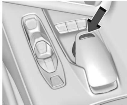
Para activar Mi Modo, Clima, Turismo, Sport y modo Pista, gire la perilla de DMC en la consola central para realizar una selección de modo. Cuando se seleccione un modo, se encenderá un indicador en el cuadro de instrumentos y permanecerá encendido. Consulte "E-Ray – Activación del modo de conducción EV" más adelante en esta sección para obtener detalles sobre la activación de los modos de conducción EV.
