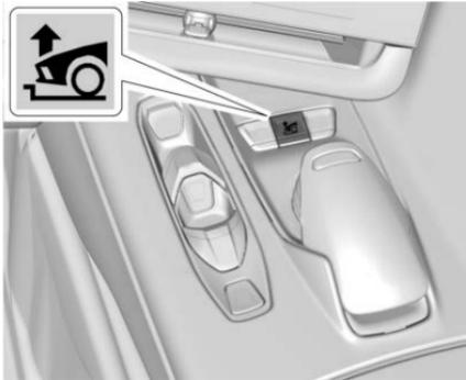
Para usar el Sistema de elevación delantera, presione el botón en la consola central para levantar o bajar el vehículo. Esta función se puede operar en velocidades hasta de 38 km/h (24 mph) cuando el motor esté en operación. El sistema funciona en base al estado o modo de operación del vehículo:
