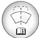
2. Abra el tapón que tiene el símbolo del lavaparabrisas. Agregue líquido para lavaparabrisas hasta llenar el tanque.
