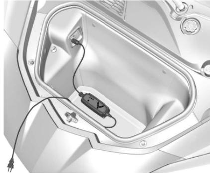
Algunos vehículos tienen un paquete de mantenedor de batería. Siga las instrucciones indicadas en el paquete de mantenedor de batería para mantener la batería cargada cuando el vehículo no esté en uso. Conecte el conservador de la batería únicamente al tomacorriente de accesorios debajo del cofre.
