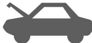
Cuando el cofre del motor está abierto, se enciende el indicador de cofre del motor abierto.
