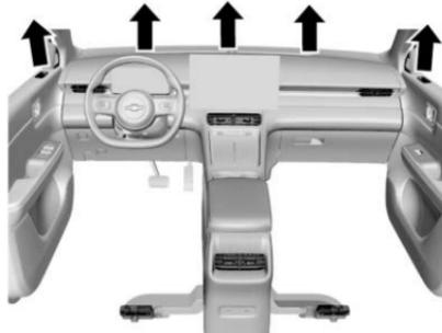
En este modo, el aire sale de la salida de aire de descongelamiento del parabrisas delantero y la salida de aire de descongelamiento de ventana de la puerta delantera.
