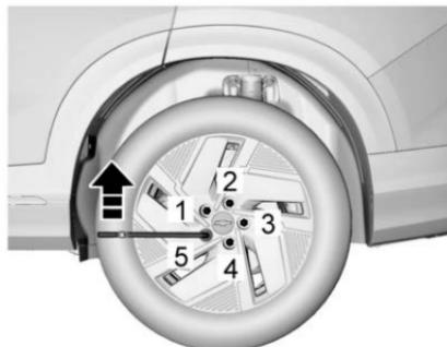
Cuando el gato hidráulico levante el vehículo, asegúrese que el gato hidráulico esté colocado adecuadamente (no colocado sobre una superficie resbaladiza).
