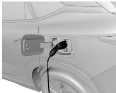
3. Presione el botón negro en el enchufe de carga e inserte el enchufe de carga en el puerto de carga (el puerto de carga lenta está en la parte superior y el puerto de carga rápida está en la parte inferior). Cuando el enchufe de carga está completamente insertado, el botón negro sobresale obviamente.
