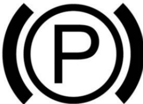
El indicador de operación del freno eléctrico de estacionamiento (EPB) se ilumina cuando se jala el freno eléctrico de estacionamiento hacia arriba. Esto indica que el vehículo está en estado de estacionamiento.
