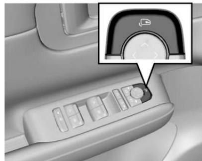
Presione el botón de pliegue eléctrico □ para plegar el espejo retrovisor exterior automáticamente.
