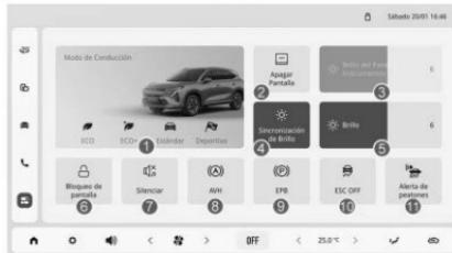
1. Toque los cuatro botones para cambiar el modo de conducción.
