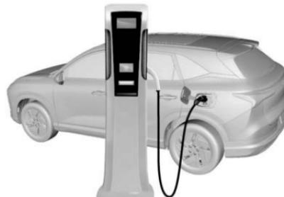
Si carga en una estación de carga CA, primero inserte el conector de carga en el puerto de carga del vehículo. Después, encienda la estación de carga. Después que se complete la carga, primero apague la estación de carga antes de retirar el enchufe de carga. Por favor siga las instrucciones de operación de la estación de carga.
