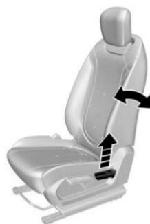
Jale hacia arriba la manija cerca del cojín del asiento ajuste el ángulo de inclinación del respaldo a una posición adecuada entonces, libere la manija. Después de ajustar el respaldo del asiento, intente sacudir el respaldo para asegurarse de que el respaldo esté bloqueado.
