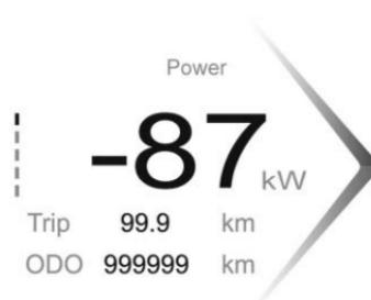
La potencia de salida se muestra como el porcentaje de energía del sistema de energía en el lado izquierdo del grupo de instrumentos. Si la energía muestra un valor positivo, significa que el sistema de energía emite potencia para impulsar el vehículo; si la energía muestra un valor negativo, significa que el sistema de energía convierte parte de la energía cinética en energía eléctrica.
