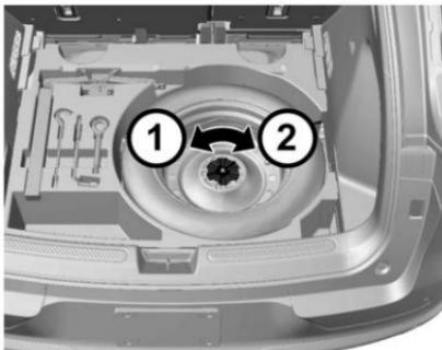
1. Abra la puerta trasera y retire el piso del compartimiento de equipaje. El gancho del piso se puede colgar en la bisagra del lado derecho de la puerta trasera.
