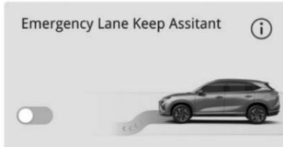
Después de arrancar el vehículo, ELK se predetermina en el estado ON (encendido). Puede encender o apagar esta función a través del interruptor "Configuración" → "Asistencia de conducción" → "ELK" en la pantalla táctil de IVI. Después de apagar el vehículo, el sistema no memorizará su selección. Una vez que el vehículo se encienda de nuevo, el estado del interruptor de función se establecerá de acuerdo con el estado encendido del sistema.
