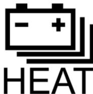
Este indicador de calentamiento del paquete de baterías se ilumina cuando el vehículo se carga a baja temperatura, que indica que el sistema calienta la batería para mantenerla cargada a una temperatura segura y confiable.
