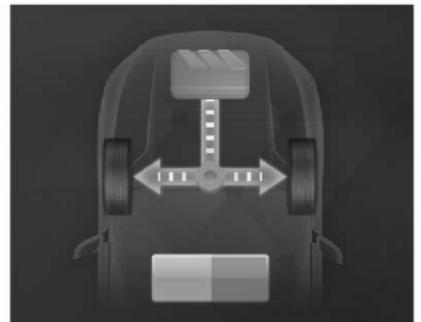
El motor impulsa el vehículo a través del embrague. Este modo de operación del vehículo se utiliza principalmente en la fase de crucero de conducción en velocidad media/alta (más de 80 km/h).
