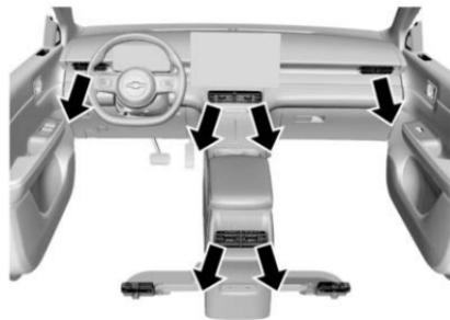
En este modo, el aire sale de la salida de aire central, la salida de aire lateral y la salida de aire de la consola.
