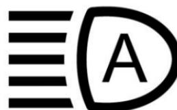
Si la luz indicadora es azul, indica que el sistema de cambio de luz alta/baja inteligente está encendido. Cuando el sistema está en estado encendido y detecta que el tráfico del camino y el entorno que se encuentra al frente han cumplido las condiciones de encendido de las luces altas, éstas se encenderán.
