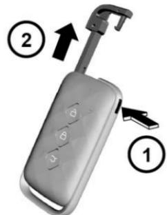
Para utilizar una llave mecánica, presione el interruptor de liberación ① en la llave y entonces extraiga la llave mecánica ②, como se muestra en la figura anterior. Vuelva a insertar la llave mecánica después del uso.
