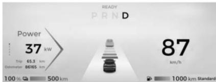
Como se muestra en la figura anterior, hay un total de 4 niveles de distancia ajustables. Presione brevemente el botón de "Izquierda" para disminuir el nivel por uno, con el más bajo siendo el Nivel 1 presione brevemente el botón de "Derecha" para subir el nivel por uno, con el más alto siendo el Nivel 4.
