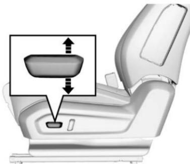
Como se muestra en la figura, mueva el interruptor de ajuste de altura en el lado exterior del cojín del asiento. Libere el interruptor después de ajustar el asiento a la altura adecuada.
