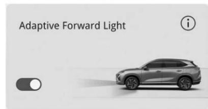
Después de arrancar el vehículo, el interruptor de luz alta/baja inteligente se Apaga de forma predeterminada. Puede activar o desactivar el interruptor de luz alta/ baja inteligente mediante "Configuración" → "Asistencia de conducción" → "Interruptor de luz alta/baja inteligente" en la pantalla táctil de IVI. El sistema recordará su elección, y el estado del interruptor de la luz alta/baja inteligente permanecerá sin cambio cuando se encienda de nuevo el vehículo.
