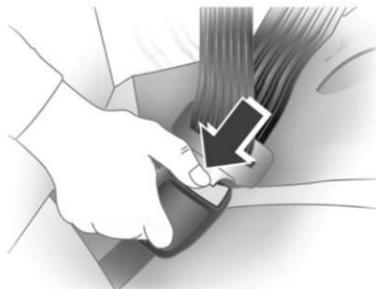
Si necesita liberar el cinturón de seguridad, presione el botón rojo en la hebilla, y la lengüeta saldrá automáticamente y el cinturón de seguridad se retraerá automáticamente. El cinturón de seguridad está bloqueado debido a que se retrae o se extrae demasiado rápido, y puede extraerse suavemente aflojando el tejido.
