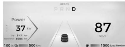
Como se indica en la figura anterior: En el instrumento, la línea lateral del carril donde se desvía el vehículo se muestra como advertencia de color naranja, indicando que existe peligro de desvío del carril.
