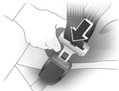
2) Inserte la placa del seguro hacia adelante (la inserción inversa de la placa del seguro hará que el cinturón de seguridad se tuerza y corte o incluso ponga en peligro la vida en caso de colisión). Insértela en la hebilla del par de asientos hasta que escuche un sonido de bloqueo de "clic" y después tire de ella para verificar si el bloqueo es confiable.
