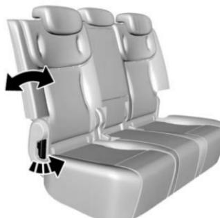
Como se muestra en la figura, levante la manija de liberación junto al asiento, ajuste el ángulo de inclinación del respaldo a una posición adecuada y después libere la manija. Intente sacudir el respaldo de nuevo para confirmar que el respaldo esté bloqueado.
