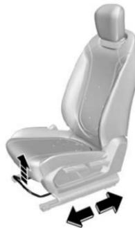
Jale hacia arriba la palanca de ajuste en la parte inferior delantera del asiento para ajustar el asiento hacia adelante o hacia atrás, y suelte la palanca después que el asiento esté ajustado en la posición adecuada.
