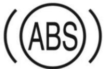
Cuando el vehículo está encendido, la luz de advertencia del ABS se iluminará momentáneamente. Indica que el sistema está realizando una inspección automática y que el foco de la luz de advertencia puede funcionar normalmente. La luz de advertencia se apagará varios segundos después. En caso de las siguientes condiciones de la luz de advertencia ABS, consulte el Centro de Servicio Postventa más cercano.
