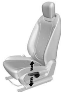
Gire la manija del lado exterior del asiento hacia arriba y hacia abajo hasta que el asiento se ajuste a la altura deseada.
