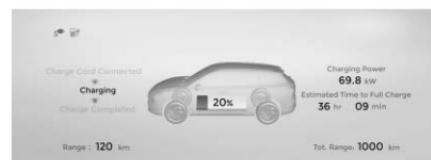
Cuando la carga sea exitosa, el grupo de instrumentos indicará que la carga está en curso. Si el ícono de estado de carga (🔋) no aparece, significa que la carga no se realizó correctamente. Por favor revise si el proceso de
