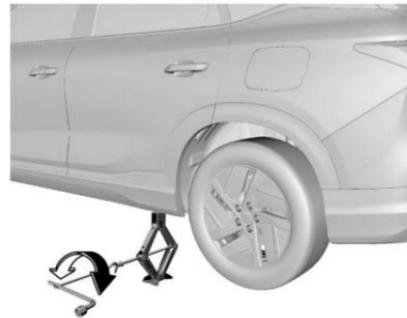
6. Gire el estribo del gato en sentido de las manecillas del reloj para permitir que el gato suba lentamente y asegúrese que la cabeza del gato esté firmemente presionada en la posición de elevación.
