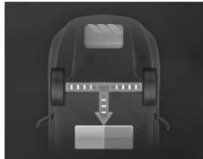
Este modo de operación proporciona recuperación de energía para el sistema de batería de tracción. Se usa principalmente en la fase de conducción media-alta (arriba de 80 km/h) cuando se aplican los frenos o se suelta el pedal del acelerador.
