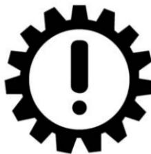
La luz de advertencia de falla de la transmisión se ilumina cuando se enciende el interruptor de ignición y se apaga varios segundos después. Esto indica que tanto la luz de advertencia como el sistema de control de transmisión automática pueden funcionar normalmente.
