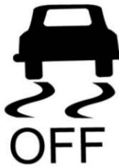
La luz de advertencia se ilumina después que se enciende la ignición y se apaga varios segundos después. Esto indica que la luz de advertencia puede funcionar normalmente.
