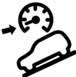
El control de descenso en pendientes (HDC) se usa para ayudar al vehículo a bajar en una pendiente pronunciada suavemente. Después de activar esta función, la luz indicadora de HDC se iluminará después que se desactive la función HDC, la luz indicadora se apagará.
