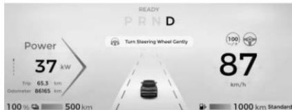
Segundo recordatorio de manos libres/control de conductor: Cuando el primer recordatorio de manos libres/control de conductor ha estado activo durante un período de tiempo y el sistema detecta que el conductor aún no está
