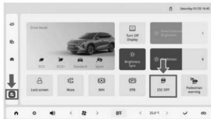
2. Como se muestra en la figura anterior, haga clic en el ícono de [Centro de control] en la barra de navegación izquierda del sistema de infoentretenimiento para abrir o cerrar el [Sistema electrónico de estabilidad]. Cuando se apaga el interruptor ESC, la luz ESC OFF en el grupo de instrumentos se iluminará. Normalmente, no se recomienda desactivar el sistema ESC. El sistema se debe deshabilitar temporalmente únicamente cuando el vehículo sale de un atolladero, sube sobre un campo nevado, etc.
