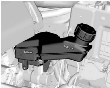
1. Limpie completamente la suciedad alrededor del tapón de llenado del depósito.
