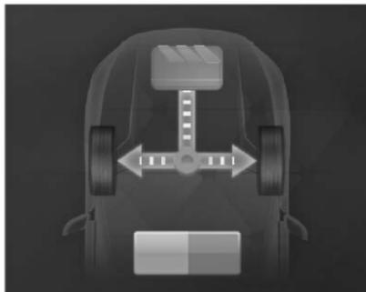
El motor, a través del generador, suministra energía eléctrica al motor de impulso, que impulsa el vehículo. Este modo de operación se utiliza principalmente en la fase de crucero en velocidades baja y media (dentro de 80 km/h), que ayuda a ahorrar energía y combustible.
