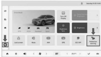
2. Como se muestra en la figura anterior, haga clic en el ícono [Centro de control] en la barra de navegación izquierda en el sistema de infoentretenimiento para ajustar a través de [Alerta de peatón].
