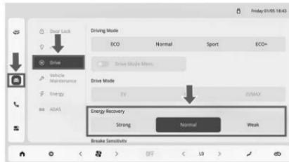
Como se muestra en la figura anterior, haga clic en el ícono [Configuración del vehículo] en la barra de navegación izquierda del sistema de infoentretenimiento o en la interfaz de aplicación completa, y ajuste a través de [Conducción-Modo de recuperación de energía].
