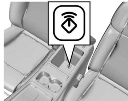
Coloque el lado de la llave inteligente con el logotipo de Chevrolet cerca de la posición de almacenamiento en la consola (como se muestra en la figura anterior). Pise el pedal del freno para poner el vehículo en estado de READY. Si no se puede desasegurar el vehículo debido a la batería baja de la llave inteligente, por favor consulte el contenido en [Llaves, Puertas, y Bloqueo de Ventanas y Puertas].
