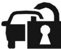
Este indicador se ilumina cuando se abre la puerta. Después de arrancar el motor, el indicador debe estar apagado, indicando que el indicador funciona normalmente. Consulte la información en el sistema de inmovilizador del motor que se proporciona en "Conducción y controles".
