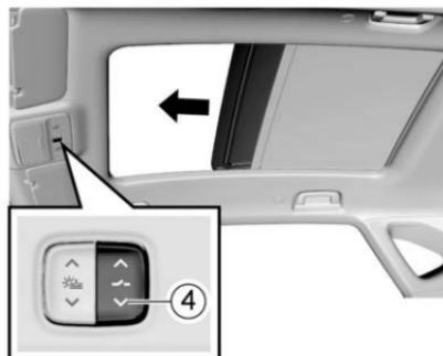
Presione [Botón ④] para cerrar automáticamente el quemacocos. Presione ④ de nuevo durante el cierre para detener el cierre. También puede presionar y sostener
