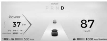
Después de que se active la asistencia de conducción inteligente, el instrumento mostrará las líneas de carril y los iconos del volante en azul. El sistema ayudará a controlar el volante y la velocidad del vehículo. El tablero de instrumentos y de control central indicará el estado de control a través de iconos y de cambios de color:
