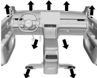
En este modo, el aire sale por la salida de aire de descongelamiento del parabrisas delantero, la salida de aire de descongelamiento de la ventana de la puerta delantera, la salida de aire del piso, la salida de aire inferior del asiento delantero y la salida de aire lateral.
