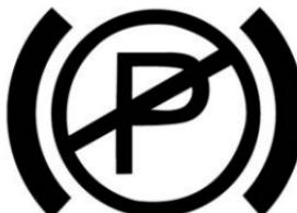
La luz de advertencia de falla de freno eléctrico de estacionamiento se ilumina después de encender el interruptor de ignición y se apaga varios segundos después. Esto indica que tanto la luz de advertencia como el módulo de función de freno eléctrico de estacionamiento puede funcionar normalmente.
