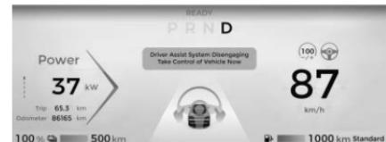
Durante el recordatorio de manos libres/control del conductor, cuando usted tome el control del vehículo, tal como girar el volante o presionar el pedal del acelerador, la función de IDA reanudará el control normal si presiona el pedal del freno, se saldrá la función de IDA y se entregará el vehículo a usted para su control.
