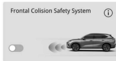
Después de arrancar el vehículo, FCS se predetermina en el estado ON (encendido). Puede encender o apagar esta función a través del interruptor "Configuración" → "Asistencia de conducción" → "FCS" en la pantalla táctil de IVI.
