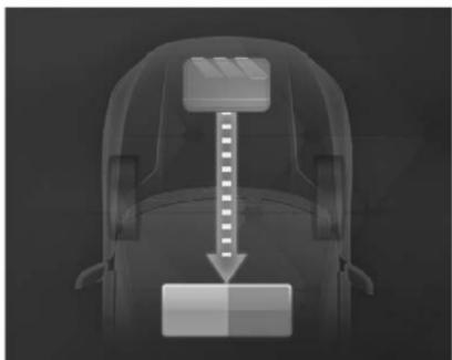
El motor carga la batería de tracción a través del generador. En este modo de operación, el vehículo está en un estado de marcha en vacío y la energía de la batería de tracción cumple con las condiciones de carga.
