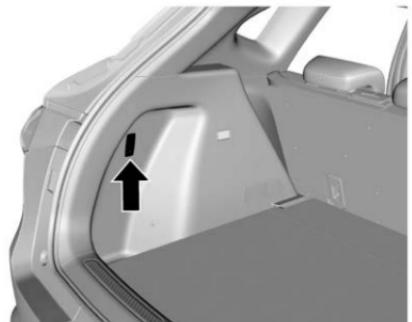
Como se muestra en la figura anterior, hay un gancho para colgar en la caja trasera, que se puede usar conforme sea necesario.
