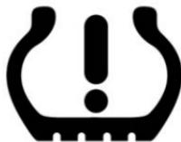
Después de encender el vehículo, la luz de advertencia se enciende brevemente y después se apaga, indicando que la luz de advertencia funciona correctamente.
