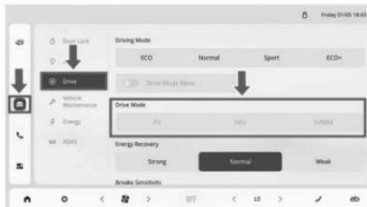
Como se muestra en la figura anterior, haga clic en el ícono [Configuración del vehículo] en la barra de navegación izquierda del sistema de infoentretenimiento o en la interfaz de aplicación completa para cambiar a través de [Conducción-Modo de conducción].
