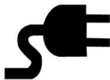
Cuando se carga el vehículo, este indicador se ilumina, indicando que el cable de carga está conectado.
