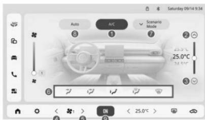
1. Toque A/C para encender el compresor de aire acondicionado.
