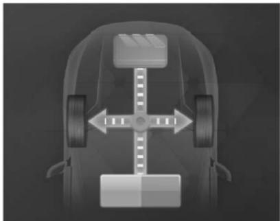
El motor proporciona energía eléctrica para el motor de impulso a través del generador, y la batería de tracción también proporciona asistencia de energía eléctrica para que el motor de impulso impulse el vehículo. Este modo de operación del vehículo se utiliza principalmente para aceleración en la fase de conducción de velocidad media-baja (dentro de 80 km/h), pero también para acelerar a altas velocidades y cuando se presiona más profundo el pedal del acelerador.
