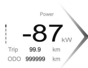
Muestra ① potencia de salida, kilometraje de viaje y kilometraje total ② presión de llantas ③ consumo promedio de energía (consumo eléctrico, consumo de combustible, consumo extensivo) por más de 50 km ④ potencia de salida, rango de velocidad constante total, kilometraje HEV ⑤ información de flujo de energía.
