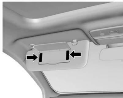
Cuando la cubierta del espejo de vanidad está abierta, la luz del espejo se encenderá y se apagará cuando se cierre la cubierta.
