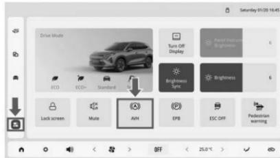
2. Como se muestra en la figura anterior, toque el ícono de [Centro de control] en la barra de navegación izquierda en el sistema de infoentretenimiento, para ajustar a través de [Sostenimiento automático].
