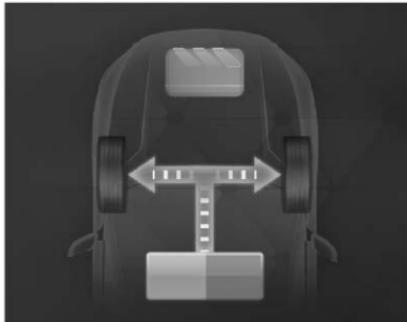
La batería de tracción suministra energía eléctrica al motor de impulso, que impulsa el vehículo. Este vehículo funciona en modo de conducción puramente eléctrico, con una batería de tracción completamente cargada, y se utiliza principalmente en la etapa de conducción de crucero, cuando el vehículo arranca o se presiona ligeramente el pedal del acelerador. En este modo, el indicador "EV" en el grupo de instrumentos se ilumina y se apaga cuando el motor está en operación.
