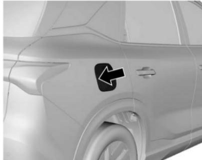
3. Como se muestra en el diagrama, presione de nuevo en el lado izquierdo de la puerta de combustible, y la puerta de combustible se abrirá. En este punto, gire la tapa del combustible en sentido contrario a las manecillas del reloj, para abrir el tanque de combustible para cargar combustible.
