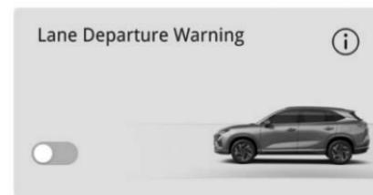
Después de arrancar el vehículo, el sistema de advertencia de desvío del vehículo se enciende de forma predeterminada. Puede
