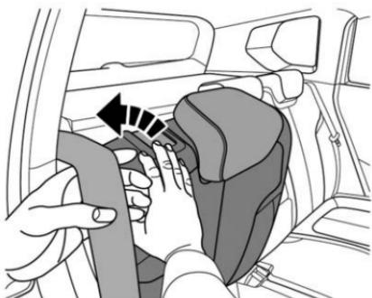
como muestra la figura, al restaurar el respaldo, para evitar que el cinturón de seguridad quede atrapado al restaurar el respaldo, jale el cinturón de seguridad primero para evitar el área donde se despliega el respaldo. Después empuje el respaldo hacia atrás para bloquearlo en su lugar. Intente sacudir el respaldo para asegurarse que esté bloqueado.
