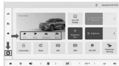
2. Como se muestra en la figura anterior, toque el ícono de [Centro de control] en la barra de navegación izquierda del sistema de infoentretenimiento para cambiar a través del [Modo de conducción].
