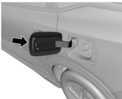
2. Como se muestra en la imagen, gire a la derecha para cerrar la cubierta del puerto de carga hasta que escuche un "clic". (Al cerrar la cubierta del puerto de carga, asegúrese que la cubierta de protección del puerto de carga esté cerrada adecuadamente.)
