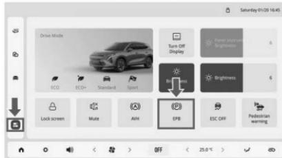
2. Como se muestra en la figura anterior, toque el ícono de [Centro de control] en la barra de navegación izquierda del sistema de infoentretenimiento, ajuste a través de [Estacionamiento electrónico].
