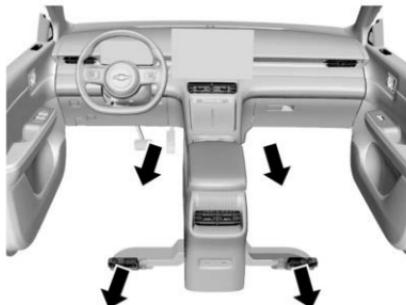
La mayor parte del aire sale de la salida de aire del piso y la salida de aire inferior del asiento delantero, un poco aire sale del parabrisas y la salida de aire del descongelador de la ventana delantera y la salida de aire lateral.
