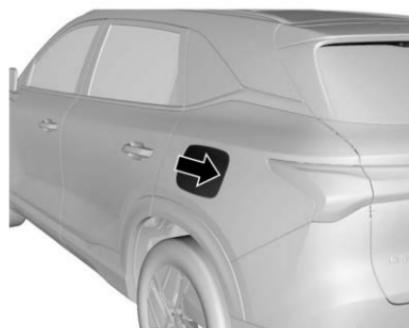
1. Como se muestra en el diagrama, el puerto de carga está ubicado en el lado trasero izquierdo del vehículo, y la cubierta del puerto de carga se abrirá automáticamente al presionar.
