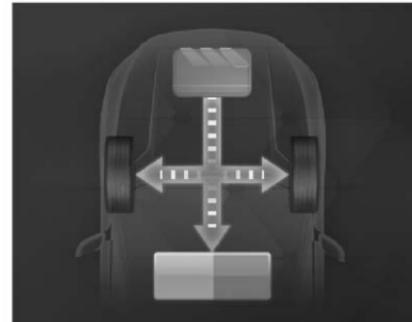
El motor suministra energía eléctrica al motor de impulso a través del generador y carga la batería de tracción al mismo tiempo, y el motor de impulso impulsa el vehículo. En este modo de operación, el vehículo está en una fase de crucero de conducción de velocidad media-baja (dentro de 80 km/h) y la energía de la batería de tracción cumple con las condiciones de carga.
