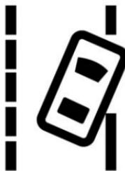
1. Cuando la función [Advertencia de cambio de carril] está activada, si el sistema juzga que el conductor no tiene una intención evidente de cambiar de dirección y se cumplen las condiciones de advertencia, la función de advertencia de cambio de carril se activará automáticamente, la luz indicadora se iluminará y el volante vibrará para recordarle al conductor el desvío del carril, y después que el vehículo funcione normalmente, la luz indicadora se apagará.
