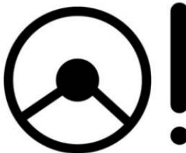
Esta luz de advertencia se encenderá inmediatamente cuando se encienda la ignición. Indica que el sistema está realizando una inspección automática y que el foco
