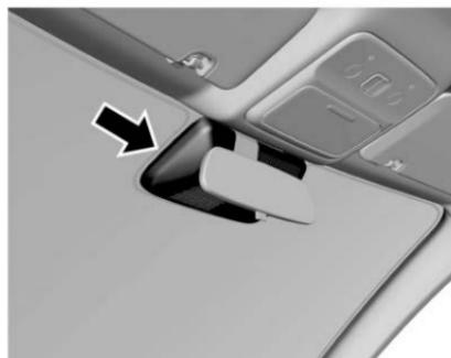
El sensor de luz y lluvia se utiliza para detectar la iluminación y vapor de agua en la superficie del vidrio y proporcionar señales de detección
