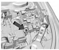
Terminal positiva (+) de batería descargada
