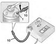
Conecte la manguera de sólo aire (10) a la válvula de entrada del recipiente de sellado (1) en el sentido de las manecillas del reloj hasta que quede apretada.
