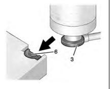
Deslice la base del recipiente de sellador de llantas (3) en la ranura en la parte superior del compresor (6) para sostenerlo hacia arriba.
