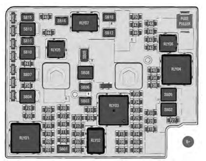
Un extractor de fusibles está en el bloque de fusibles del compartimiento debajo del cofre.
