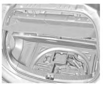
Levante la cubierta del piso de carga para obtener acceso al sistema de administración de carga, si está equipado. Hay un área de almacenamiento abierta con alfombra. Retire la alfombra y la cubierta para tener acceso a almacenamiento adicional.
