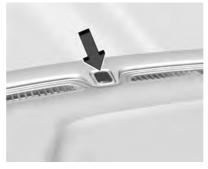
La luz indicadora roja, en el tablero de instrumentos, cerca del parabrisas, indica el estado del sistema:
