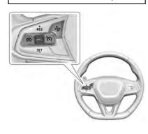
${}^{\bigotimes}$  : Presione para encender o apagar el sistema. El indicador se pone blanco en el grupo de instrumentos al activarse el ACC.
