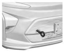
Instale la armella de arrastre en el receptáculo y gírela hasta que esté completamente apretada. Al retirar el ojo de remolque, vuelva a instalar la cubierta en la posición original.
