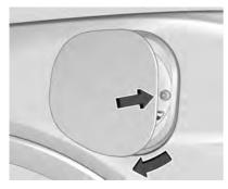
2. Empuje el borde trasero de la puerta del puerto de carga y suéltelo para abrir. En condiciones de clima frío, se puede formar hielo alrededor de la puerta del puerto de carga. Retire el hielo del área antes de intentar abrir o cerrar la puerta del puerto de carga.
