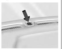
El vehículo tiene un Indicador de estado de carga (CSI) en el centro del tablero de instrumentos cerca del parabrisas. Cuando el vehículo se conecta y la energía del vehículo está apagada, el CSI indica lo siguiente:
