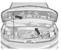
Levante el cofre y libere la varilla del soporte del cofre de su retenedor en el frente del compartimiento del motor. Inserte firmemente el extremo de la varilla en la ranura marcada con una flecha, en el lado inferior del cofre.
