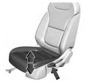
Mueva la palanca en la parte exterior del asiento hacia arriba o abajo para ajustar manualmente la altura del asiento.
