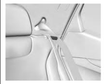
Asegúrese que el cinturón de seguridad esté en el sujetador del cinturón de seguridad en la moldura lateral del vehículo.
