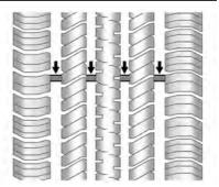
Los indicadores de desgaste del dibujo son una de las maneras de decidir cuándo es el momento para nuevas llantas. Los indicadores de desgaste aparecen cuando las llantas tienen solamente 1.6 mm (1/16 de pulgada) de dibujo remanente. Vea Inspección de llantas ⇔ 278 y Rotación de la llanta ⇔ 278.
