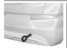
Instale la armella de arrastre en el receptáculo y gírela hasta que esté completamente apretada. Al retirar el ojo de remolque, vuelva a instalar la cubierta en la posición original.
