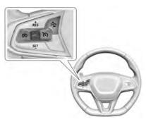
S: Oprima para encender y apagar el sistema de control de velocidad constante. Se enciende un indicador blanco en el grupo de instrumentos cuando se enciende el control crucero.
