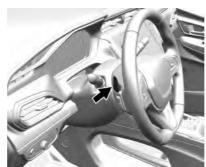
Regen on Demand (Regeneración por solicitud) permite la desaceleración incrementada al presionar y sostener la palanca del volante. Funciona en D (Conducción). Regen on Demand puede agregar frenado regenerativo adicional cuando se active el modo de Conducción de un pedal. El pedal del acelerador se puede utilizar para administrar la desaceleración mientras se utiliza Regen on Demand. Vea "Conducción con un pedal" en Unidad eléctrica de impulso ⇔ 193.
