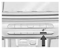
Isi está equipado, presione para encender o apagar. Aparece una luz indicadora en el botón cuando la función está encendida.
