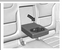
Si está equipado, baje el descansabrazos para obtener acceso a los portavasos traseros. El revestimiento es removible para limpieza.
