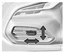
Mueva las tablillas para cambiar la dirección del flujo de aire.
