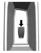
4. Abra la consola central. Coloque la llave remota en la ubicación de respaldo con los botones viendo hacia abajo.
