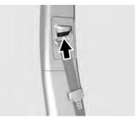
Presione y sostenga el botón de liberación mientras levanta o baja el ajustador de altura a la posición deseada.
