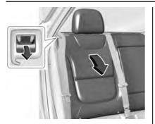
2. Jale la palanca en la parte superior del respaldo para desbloquear el respaldo.
