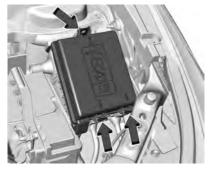
Para abrir la cubierta del bloque de fusibles, presione los sujetadores en el lado y atrás y jale la cubierta hacia arriba.
