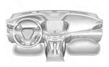
La bolsa de aire de rodillas del conductor está debajo de la columna de dirección. La bolsa de aire de rodillas del pasajero está debajo de la guantera.
