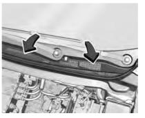
La admisión de aire en la base del parabrisas bajo el cofre se debe mantener libre para permitir el flujo de aire en el vehículo. Limpie cualquier hielo, nieve u hojas.
