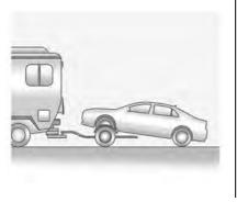
Remolque el vehículo con las dos ruedas traseras en contacto con el suelo y las ruedas delanteras colocadas sobre un "dolly".
