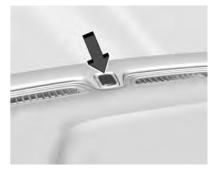
Hay un sensor de luz en la parte superior del tablero de instrumentos. No cubra el sensor, de otra manera los faros se encenderán cuando no sea necesario.
