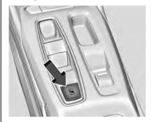
Para usar Conducción de un pedal, presione el botón One-Pedal Driving en el control de interruptor de cambio de la Unidad de tracción eléctrica. Un indicador se muestra en el grupo de instrumentos. Cuando se activa, esta función se aplica tanto en D (Conducción) y R (Reversa). Esta función permanece activa hasta que el conductor la desactive manualmente. Presione el pedal del acelerador a la velocidad deseada. La desaceleración proporcionada por Conducción
