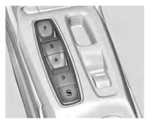
Los interruptores de cambio están en la consola central. La posición de velocidad seleccionada se iluminará en rojo en el interruptor de cambios, mientras que todas las demás se mostrarán en blanco. Si el cambio no es inmediato, como en condiciones muy frías, el indicador en el interruptor de cambios puede parpadear hasta que esté completamente accionado.
