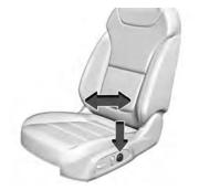
Si está equipado, oprima sin soltar la parte delantera o trasera del control para aumentar o disminuir el soporte lumbar.
