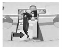
Vaya al frente del vehículo y localice la palanca de liberación secundaria debajo del centro delantero del cofre. Empuje la palanca de liberación secundaria del cofre a la derecha para liberar.
