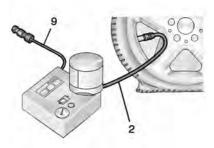
Coloque la manguera de aire/sellador (2) al vástago de la válvula de la llanta, haciéndola girar en sentido de las manecillas del reloj hasta que esté apretada.
