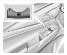
Presione 密 en la puerta del conductor para activar el bloqueo de ventana. La luz indicadora en el interruptor se iluminará cuando se active.
