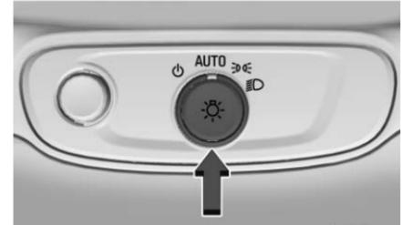
El control de lámparas exteriores está en el tablero de instrumentos a la izquierda de la columna de la dirección.
