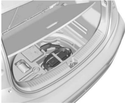
3. Abra la puerta trasera, levante la cubierta del piso de carga, y retire el cable de carga.
