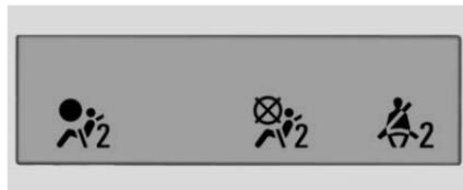
El sistema de sensor del pasajero apaga la bolsa de aire delantera exterior y la bolsa de aire para rodillas del pasajero bajo ciertas condiciones. Ninguna otra bolsa de aire es afectada por el sistema de detección de pasajeros. Consulte *Sistema de detección de pasajeros* ⇨ 87 para obtener información importante.
