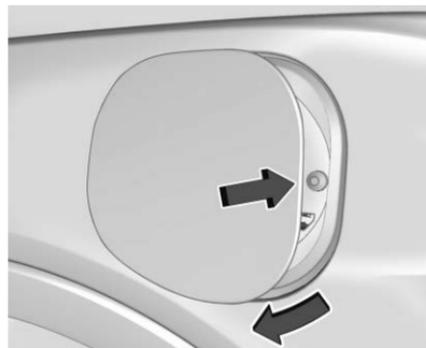
2. Empuje el borde trasero de la puerta del puerto de carga y libere para abrir la puerta.
