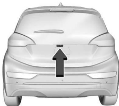
La cámara que proporciona la imagen de Espejo de cámara trasera (RCM) está arriba de la placa de circulación, junto a la Cámara de visión trasera (RVC).
