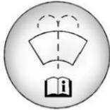
Abra el tapón que tiene el símbolo del lavaparabrisas. Agregue líquido para lavaparabrisas hasta llenar el tanque. Vea en *Resumen de compartimiento debajo del cofre* ⇨ 286 la ubicación del depósito.
