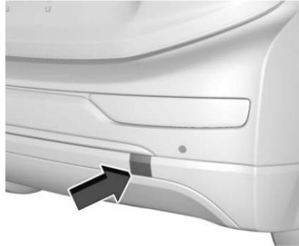
Abra cuidadosamente la cubierta en la fascia usando la ranura pequeña que guarda el receptáculo de la argolla de remolque.
