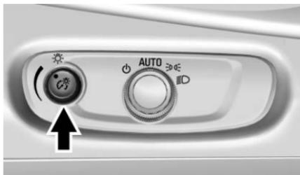
Se pueden ajustar el brillo de la pantalla del grupo de instrumentos, pantalla y controles de infoentretenimiento, controles al volante, y todos los demás controles iluminados, así como los indicadores de estado de función.
