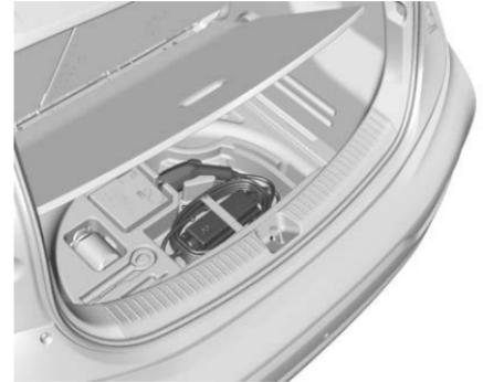
3. Abra la puerta trasera, levante la cubierta del piso de carga y retire el cable de carga.
