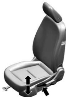
Mueva la palanca en la parte exterior del asiento hacia arriba o abajo para ajustar manualmente la altura del asiento.
