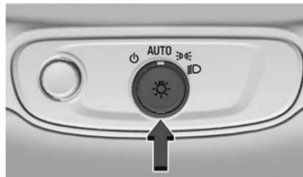
El control de la luz exterior está en el tablero de instrumentos, a la izquierda de la columna de la dirección.
