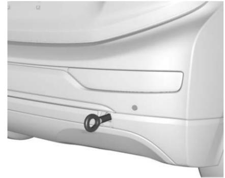
Instale la armella de arrastre en el receptáculo y gírela hasta que esté completamente apretada. Al retirar el ojo de remolque, vuelva a instalar la cubierta en la posición original.
