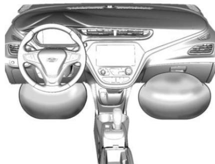
La bolsa de aire de rodillas del conductor está debajo de la columna de dirección. La bolsa de aire de rodillas del pasajero está debajo de la guantera.
