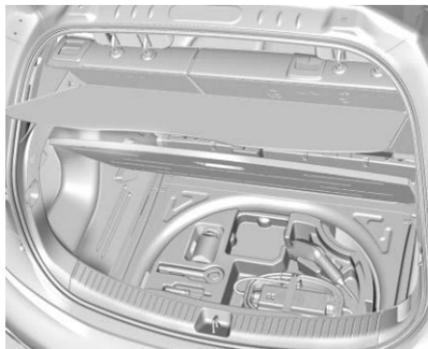
Levante la cubierta del piso de carga para obtener acceso al sistema de administración de carga, si está equipado. Puede haber un área de almacenamiento abierta con alfombra. Retire la alfombra, si está equipado, y la cubierta para tener acceso a almacenamiento adicional.
