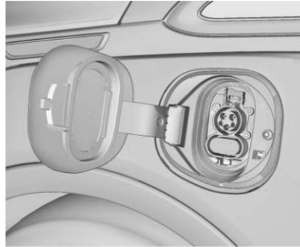
5. Conecte el conector CA del vehículo del cable de carga en el puerto de carga en el vehículo. Asegúrese que el conector CA del vehículo esté completamente conectado a puerto de carga CA. La carga puede no ocurrir si no está asentado adecuadamente.
