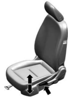
Mueva la palanca en la parte exterior del asiento hacia arriba o abajo para ajustar manualmente la altura del asiento.
