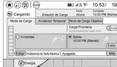
**Salida** : El vehículo programará la carga para completarse a la hora de salida programada. El vehículo estima el horario de carga basado en los horarios de salida programados, los límites de la tarifa de carga, la preferencia y programación de la tarifa eléctrica y la configuración de carga prioritaria. Si no hay tiempo suficiente después de que el cable de carga esté enchufado, el vehículo no estará completamente cargado para la hora de salida.
